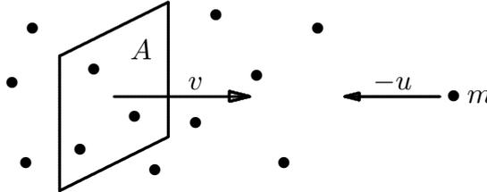
Teilchen der Masse  $m$  und einer zu  $v$  parallelen Geschwindigkeitskomponente  $u$  werden bei einem Stoß ihren Impuls um die Größe  $2m(v - u)$  ändern. Die Wahrscheinlichkeitsdichtefunktion für die Geschwindigkeitskomponente  $u$  der Teilchen werden wir mit  $f(u)$  bezeichnen, sodass auf jeden Fall
